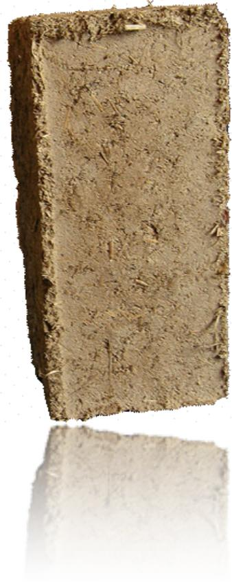
Um die Mauerwerksfestigkeit zu erhöhen, können die Steine in der Lagerfuge vorgehästet werden. Ein Vermauern der Steine erfolgt mit Leichtlehm-Mauermörtel.
